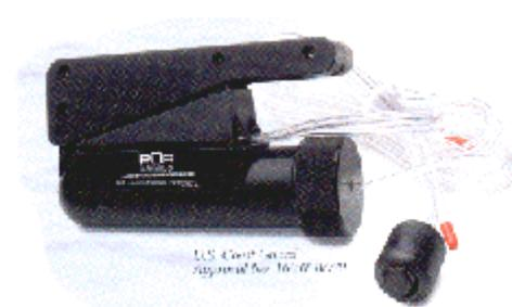
Dieser kleinste Entsalzer ist aufgrund seiner Kompaktheit besonders geeignet, in die Notfalltasche oder Rettungsinsel beige packt zu werden, er wurde entwickelt für die Überlebensausrüstung von Fliegern. Bei einer Handpumpleistung von 40 Schlägen / min. leistet er nahezu 1 Liter bestes Trinkwasser pro Stunde. Er wiegt lediglich 1.3 kg bei einer Größe von
