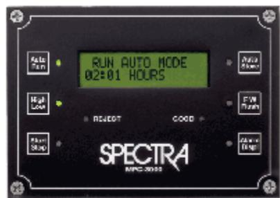
Nützlich, aber leider sehr teuer ist das für alle Spectra-Anlagen optional für rund 1.000 £ erhältliche Monitoring- und Controllerpanel MPC-3000: Die Anlage läßt sich hiermit komplett fernsteuern, Druck und Output abrufen, eine wählbare Produktionsmenge einstellen und eine alle 5 Tage automatische Frischwasserspülung zur Konservierung zB bei begrenztem Hafenaufenthalten einstellen.
